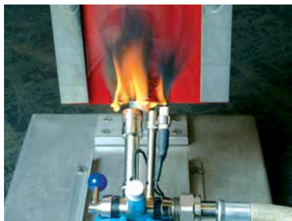
Limite d'incandescence : 3s après le retrait de la flamme
