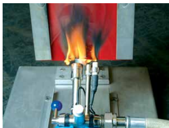
Límite de incandescencia: 3 segundos después de que la llama se retira
